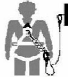
شکل ۱۱۲- نحوه صحیح استقرار در ارتفاع با ابزار متوقف‌کننده
