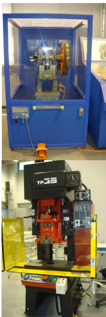
حفاظ‌های اختصاصی (Special guards): که برای ماشین‌ها و عملیات خاص مورد استفاده قرار می‌گیرند.
