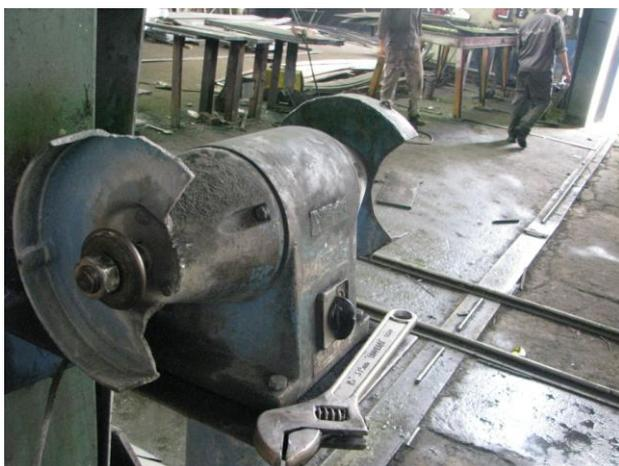
۲. جراحات چشمی: استفاده از عینک حفاظتی و حفاظ‌های شفاف ثابت در روی دستگاه، خصوصاً دستگاه‌های ثابت، برای جلوگیری از پرتابه‌ها ضروری است.
