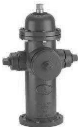
هیدرانت‌های مورد استفاده در آتش‌نشانی عموماً در سه سایز ۱/۵، ۲ و ۳/۵ اینچ بوده و توسط لوله‌هایی با همین سایز به شبکه‌های آب آتش‌نشانی متصل می‌شود. فاصله هر دو هیدرانت مجاور ۵۰ متر می‌باشد. هیدرانت‌ها در خروجی خود باید دارای فشار ۷۰ متر آب معادل ۷ اتمسفر باشند. اسپرینکلرها در خروجی خود باید دارای فشار ۳۰ متر آب معادل ۳ اتمسفر باشند. باید توجه داشت که سرعت آب در شبکه‌های اطفاء حریق نباید از ۳/۰۴۸ متر بر ثانیه افزایش داشته باشد.
